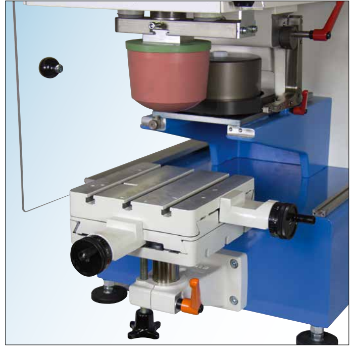
Exemple de montage d'une table croisée en aluminium
