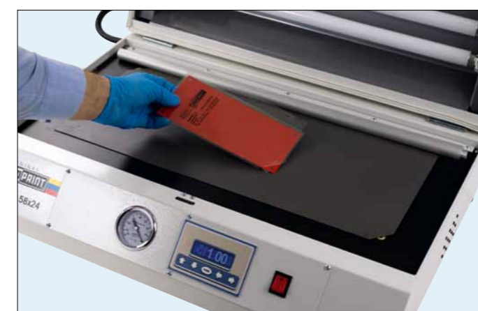
Pose du cliché, du film de montage et du film sur la table d'insolation
