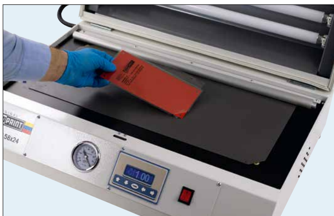
Pose du cliché, du film de montage et du film suret sur la table d'insolation
