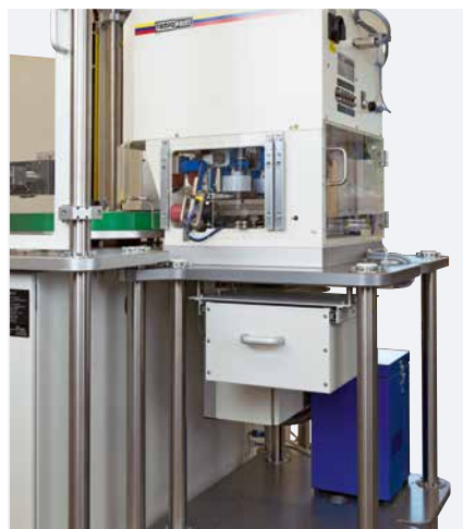
Extension du satellite à l'arrière de la machine avec un accès facile aux unités d'impression
