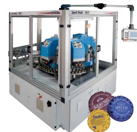
SPEED MODUL 2010 automation standardisée avec plateau tournant NC grande vitesse
