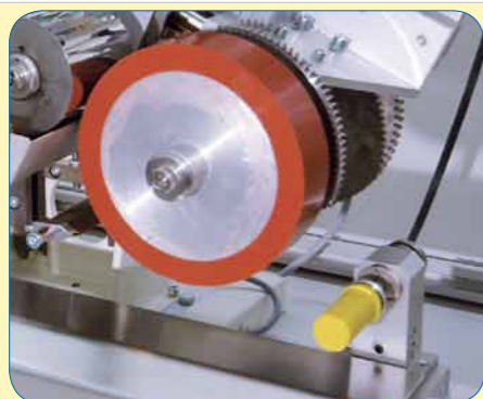
Porte-pièce en position de chargement
