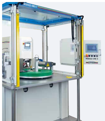
Ergonomie : Console de commande pivotante facile d'utilisation
