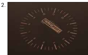
III. : gravure laser de mauvaise qualité
