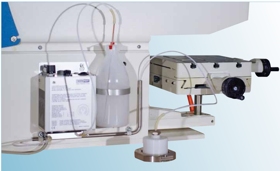
III: Ejemplo de sistema dosificador de diluyente "hermetic" montado en máquina de tampografía
