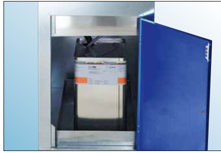
Espacio de almacenamiento para el detergente integrado en el dispositivo de limpieza (detergente no incluido en el volumen de suministro)
