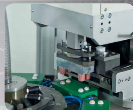
Vollautomation mit 4fach Nutzen 36.000 Teile/h
