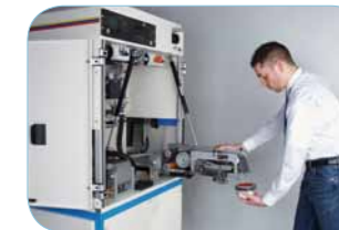
Integrierte Lasereinheit zur Druckklischeefertigung
