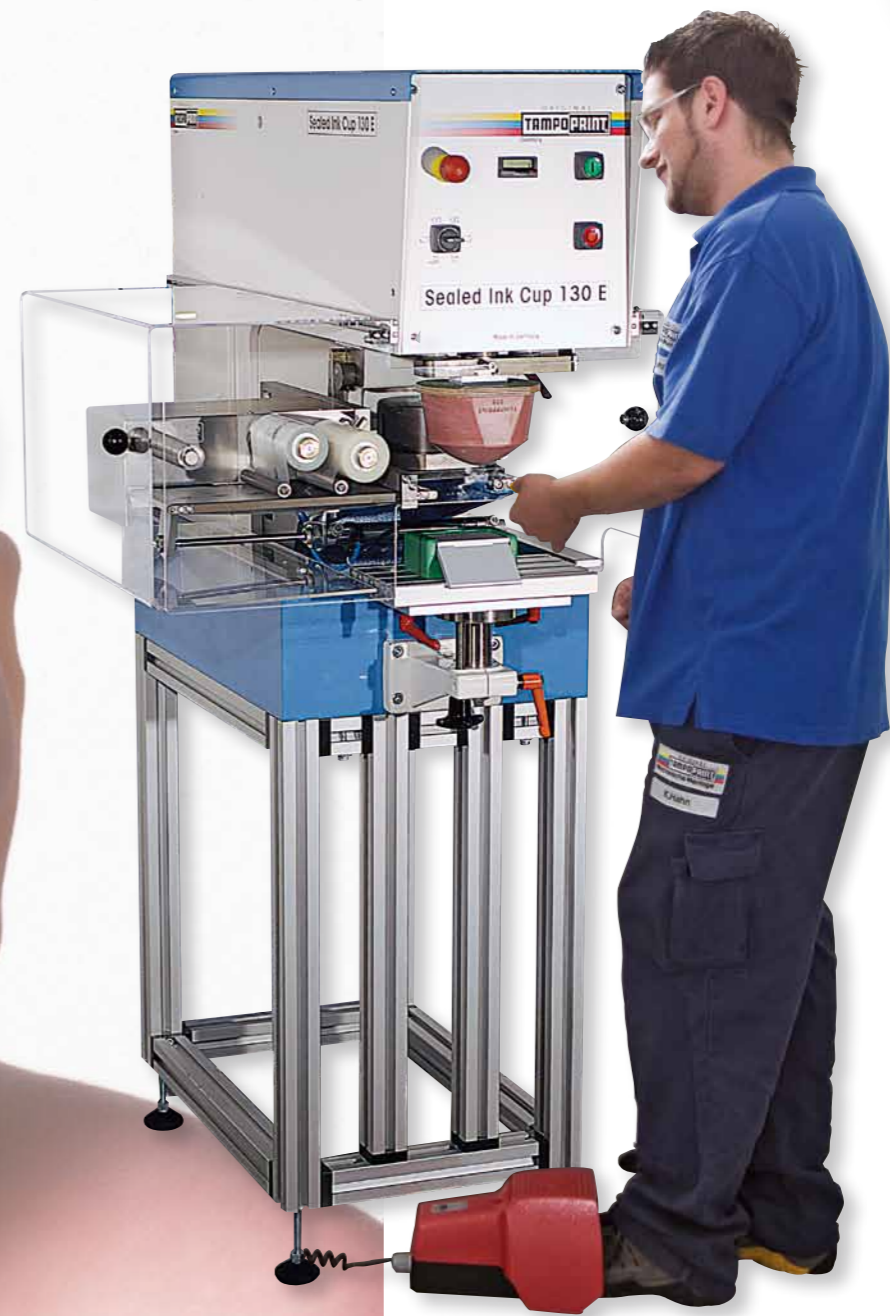
"Sealed Ink Cup 130 E", équipée avec un système d'enlèvement des encres résiduelles, bâti profilé en aluminium et un x/y chariot croisé, est un poste de travail autonome et ergonomique.
