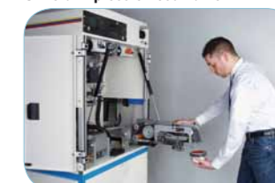
Unité intégrée de laser pour la réalisation de clichés à imprimer
