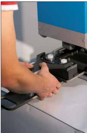
Pose/dépose de l'unité d'impression avec pince de préhension spéciale et table de montage
