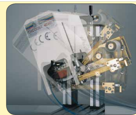
"ENCODER /1" – Posición de montaje entre 90-180° con sistema limpiador de tampones
