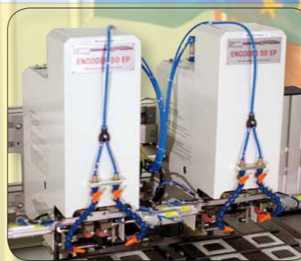
Automatización con ventilación del tampón para mercos de enchufe
