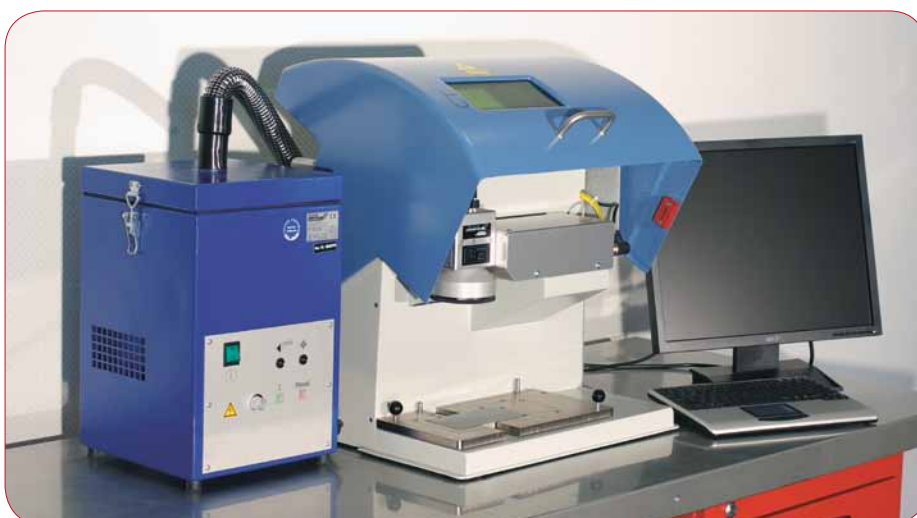
Láser de sobremesa para clichés "CT-60" con unidad de succión y filtro incorporada
