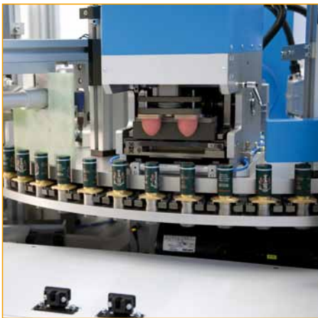
Ejemplo de combinación de una "TOP SPIN LC" (impresión circular) + "Speed Modul" (impresión en zona superior) imprimiendo en tapon es alargados.
