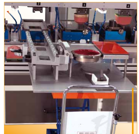
Img.: "Cliché Unit 210" (opcional) - Asistencia de montaje para cambio de cliché/tinta
