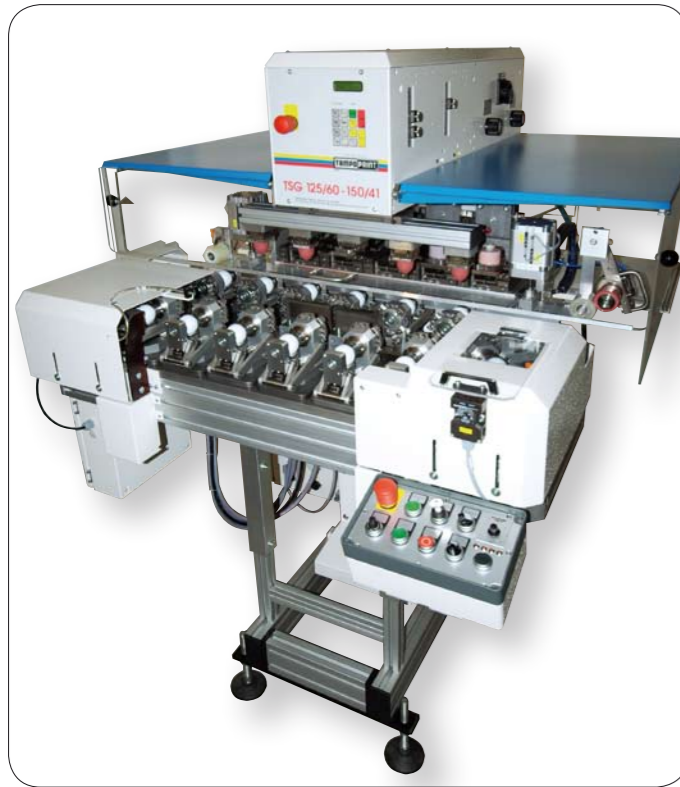
TSG 125/60-150/41 Sonderausführung - Präzisions-Mehrfarbindruck auf Golfbällen
