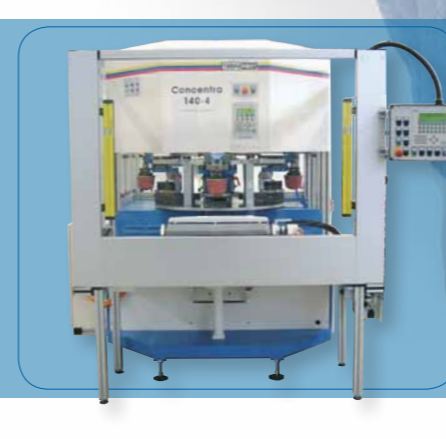
Halbautomat für "Weiße Ware" (w-x-y-z + r-Achse)
