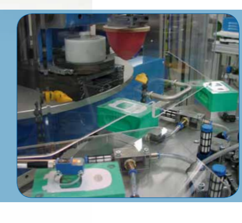
"Concentra 90-4" mit Rundschaftteller, Werkstückaufnahme m. Vakuum-Unterstützung
