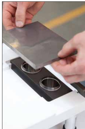
Farb-/Rakeltopfbrücke mit 2x Ø 42 mm Farb-/Rakeltöpfen
