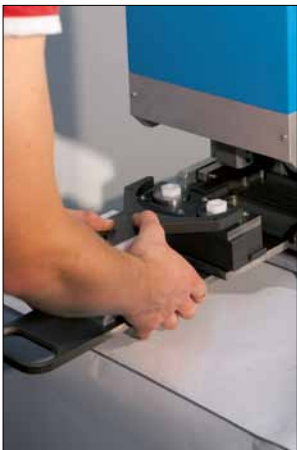
Ein-/Ausbau der Druckeinheit mit spezieller Greifzange und Montagetisch
