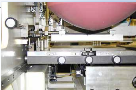
Abb.: TS 450/41 Referenzmaschine 2-Farben-Ausführung Bedrucken von Satellitenschüsseln
